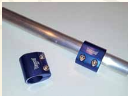
Figura 4. Morsetti utilizzati per fissare i tubi
