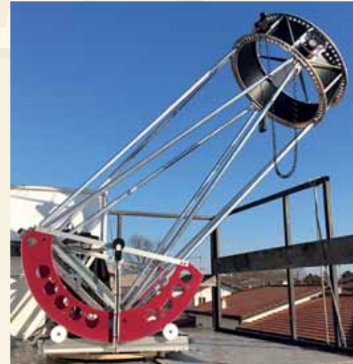
Figura 7. Il Dobson da 60 cm F/3.5 di recente realizzazione dove si nota l'evoluzione nella costruzione della struttura
