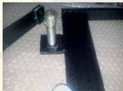
Figura 6. Gli appoggi laterali dello specchio primario
