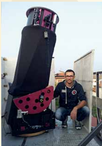
Figura 5. Il Dobson da 50 cm f/4 terminato nella postazione fissa sul tetto di casa
