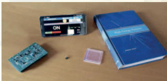
**Figura 2.** In foto la scheda ArduSiPM il piccolo rivelatore SiPM e lo scintillatore plastico.
